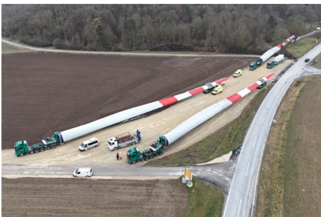
Transport von Rotorblättern: Spezialfahrzeuge manövrieren die riesigen Bauteile durch enge Kurven
