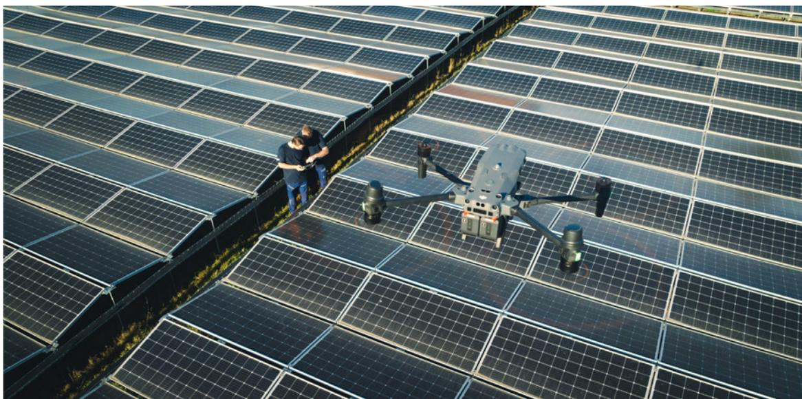
Mithilfe einer Drohne mit Wärmebildkamera suchen Techniker nach schadhaften Modulen.
