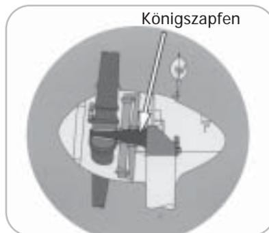
dem Generator. Enercon führt diesen Materialfehler auf falsche Stahlmischungen zurück und ersetzt daher den riss- und bruchanfalligen Bauteil rasch und kostenlos.
