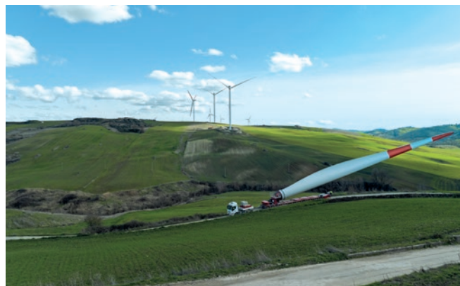
Dank sogenannter Bladelifter ist der Transport von Rotorblättern auch auf kurvenreichen Straßen leichter möglich.
